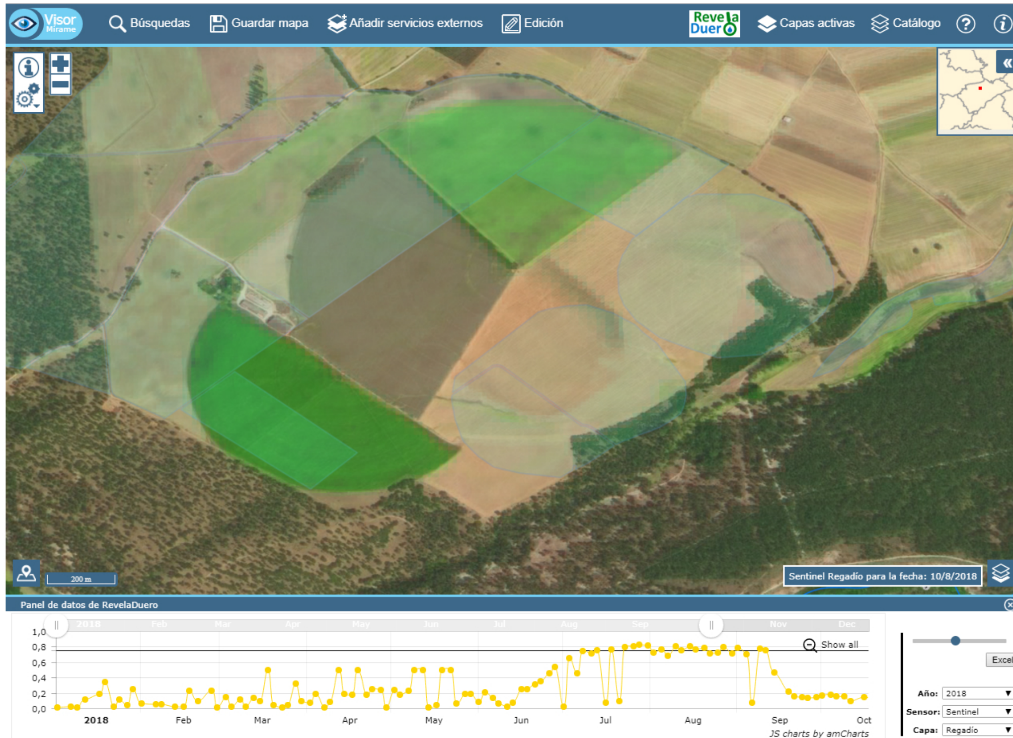
Análisis por teledetección de la actividad de regadío en la parte española de la demarcación del Duero.
